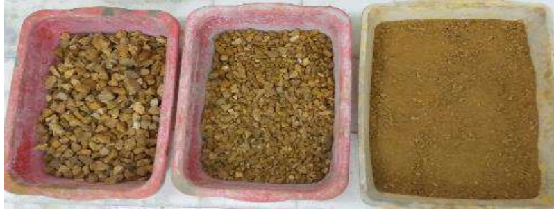
Şekil 4. Çeneli kırıcıda kırılmış sınıflarına ayrılmış limonit kayacı
