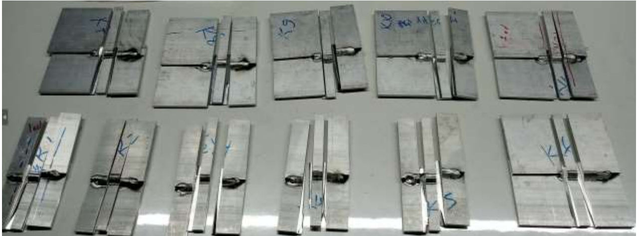
Şekil 2. Bindirme kaynak deneme parçaları ve koparma test numuneleri
